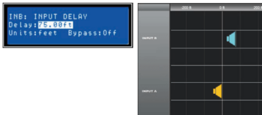
Abbildung 5.1: Als Delay für Eingang B wurde ein Wert von 75 Fuß (ca. 23 Meter) eingestellt. In der Darstellung befindet sich das Lautsprecher-Array B 75 Fuß vor dem Hauptlautsprecher-Array A. Der Einfluss der Lufttemperatur wird bei der Berechnung der Gesamtverzögerungszeit automatisch berücksichtigt. Die entsprechende Einstellung des Temperaturwerts nehmen Sie im Setup-Menü vor.
